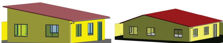
**Figura 4.2** - Telhados com uma ou duas águas.
