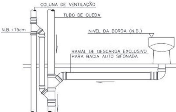
**Figura 2.2** - Esquema vertical - prumadas (NBR 8.160/1999).
