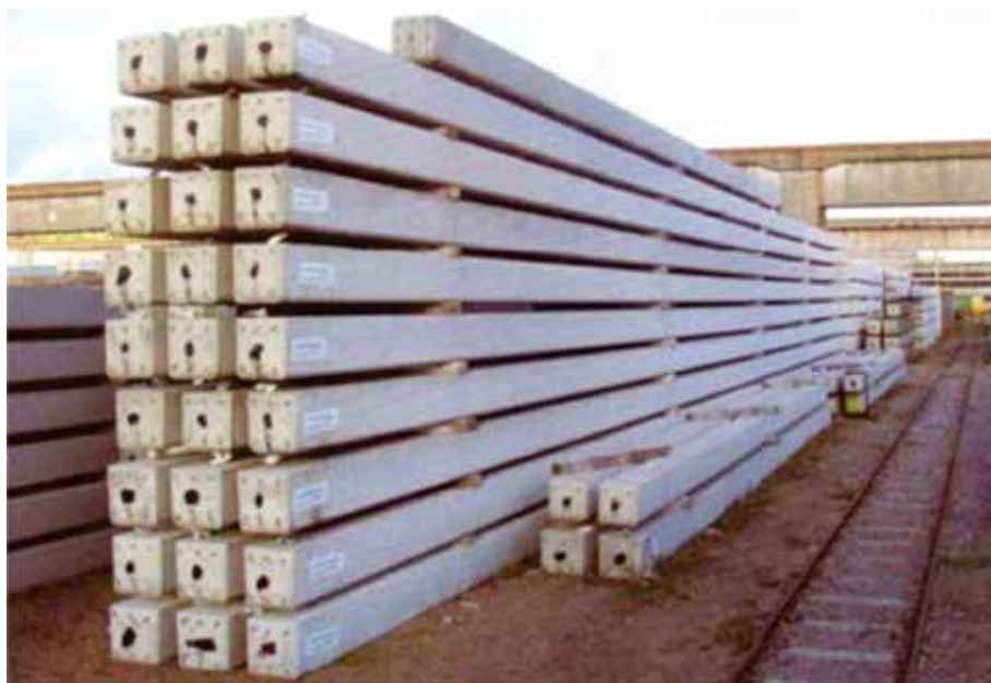
Figura 2 • Pilares de fundação executados com CAA
